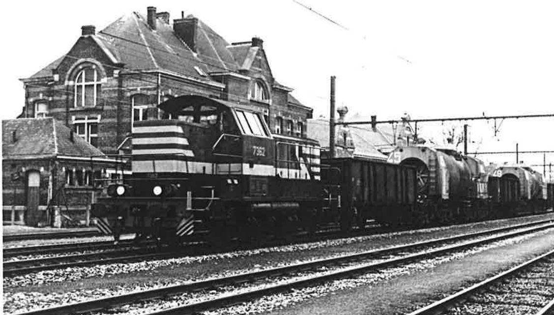
Des poches de fonte en fusion devant notre repaire de Haine-Saint-Pierre - photo Raphaël Renuart
